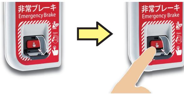
※運転者自らが体調の異変等により非常ブレーキを操作し緊急停止させることができます。
