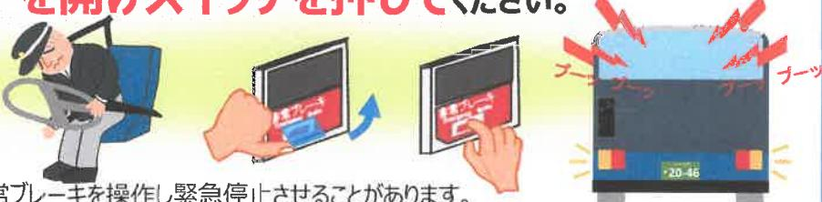
※運転者自らが体調の異変等により非常ブレーキを操作し緊急停止させることができます。
